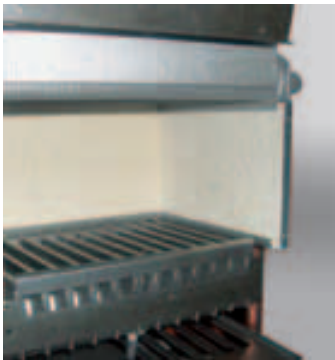
Camera di combustione: scambiatore bitermico (sopra) e bruciatore in acciaio inox (sotto)
